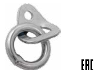
ШЛЯМБУРНОЕ УХО С КОЛЬЦОМ Шлямбурное ухо с кольцом для организации анкерных точек. Под анкер 10 мм или 12 мм
