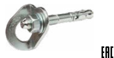
ШЛЯМБУР В СБОРЕ Шлямбурное ухо с анкером для организации анкерных точек.
