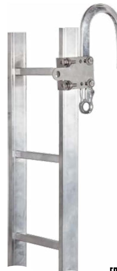
ТРАВЕРСА vpro A266 Устройство для организации точки анкерного крепления на горизонтальных элементах конструкции диаметром до 110 мм – траверса, балка и т.д. Монтируется на тетиву переносной лестницы любого типа.
