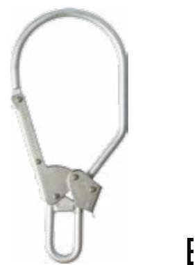
КАРАБИН ПРУТКОВЫЙ vpro A259 Стальной прутковый карабин для организации анкерных точек на элементах конструкции. Нагрузка, kN: 23. Раскрытие, мм: 87
